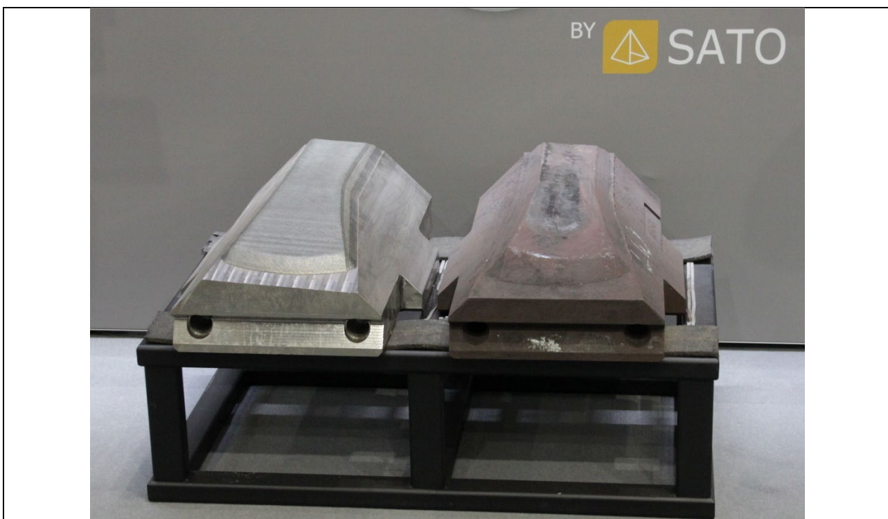
Kuva 3. IN718-nikkelisuperseoksella korjattu taontatyökalu (vasemmalla) ja alkuperäinen osa (oikealla). Kuva: Erik Haapa.
