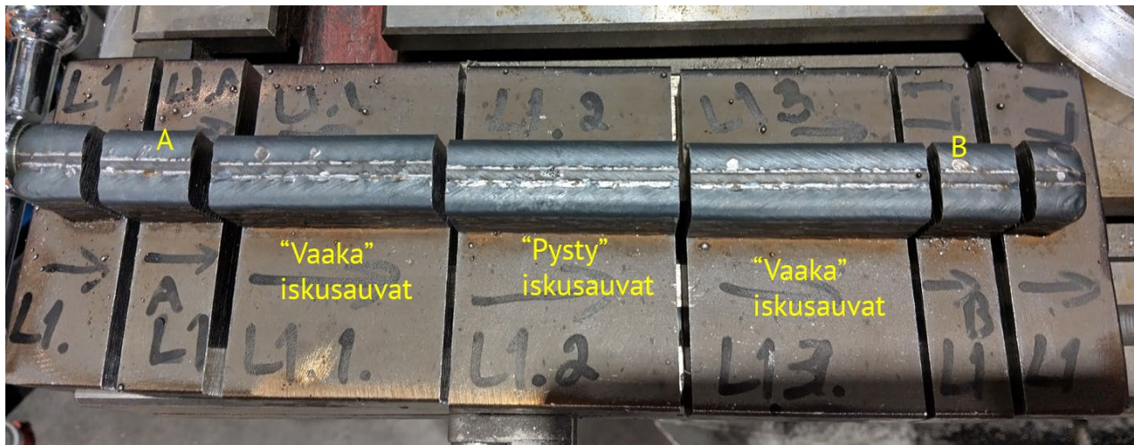
Kuva 10. L-sarjan koekappale DED-Arc kerrostuksesta. Kappaleen palastelu metallografiaa, kovuus- ja iskutitkeys-kokeiden testikappaleiden valmistusta varten. Hitsaussuunta vasemmalta oikealle.
