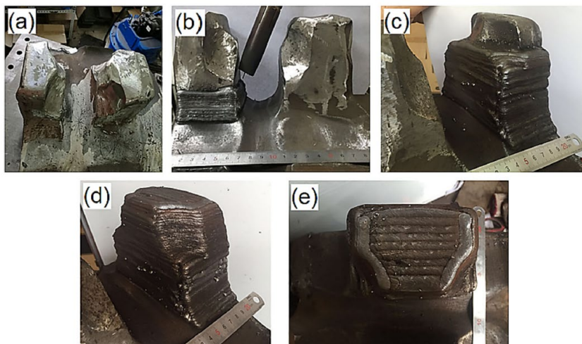
Kuva 30. WAAM menetelmällä korjattu ketjupyörä a) ennen korjausta b) kymmenen kerroksen jälkeen c) ennen vinoa pintaa d) ja e) korjattu valmis kappale (Kanishka, K. ym. 2023).
