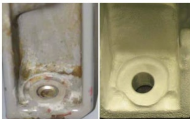
Kuva 37. UH-60-helikopterin päävaihteiston korvakkeen korjaus kylmäruiskuttamalla (Häkkinen, O. 2021.)
