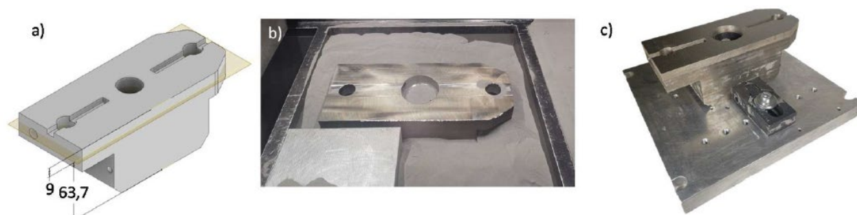
Kuva 27. a) leikkauspinta b) osa tulostimessa c) osa tulostuksen jälkeen (Wurst, J. ym. 2023)
