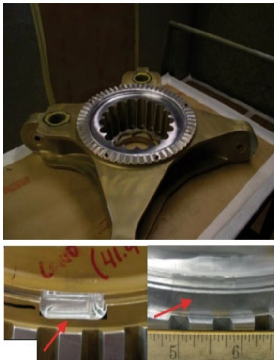
Kuva 38. AH-64-helikopterin maston tuen korjaus (Häkkinen, O. 2021.)
