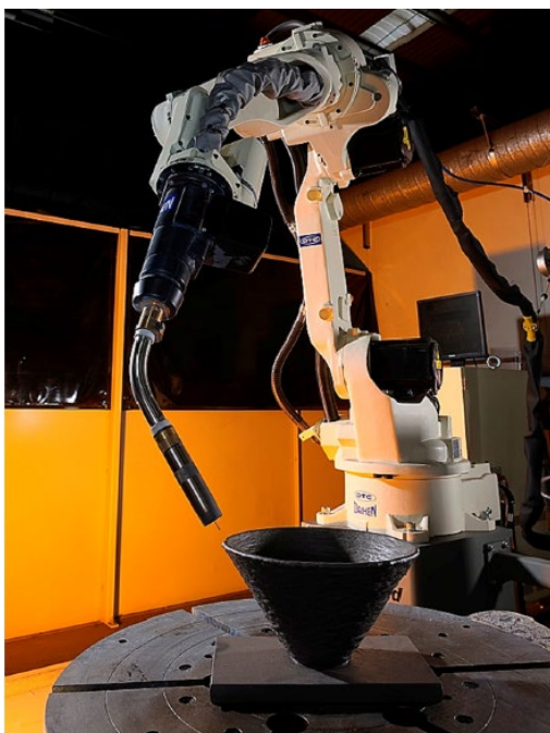
Kuva 29. WAAM periaate (Kanishka, K. ym. 2023).
