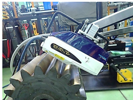
Kuva 43. Hammaspyörän röntgentarkastus (National Institute for Materials Science. 2021)
